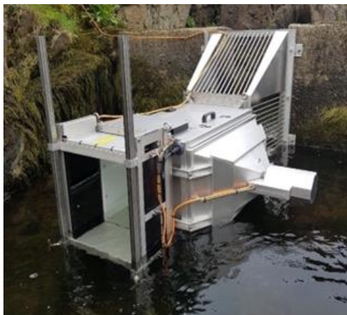
Mynd 5. Teljari í Laugardalsá í Ísafjarðardjúpi er útbúinn með skynjurum, myndavél og ljósum (vinstri). Lax á göngu upp teljara í Laugardalsá 29.júní 2020 (hægri).
