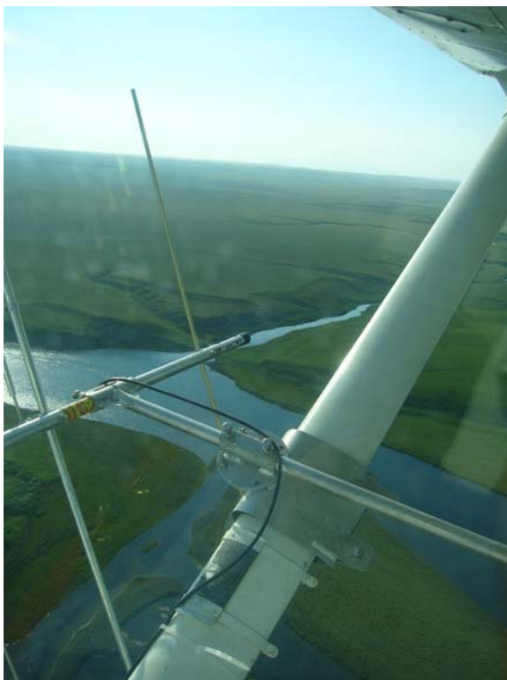
Ljósmynd 1. Flogið yfir Rangá við ós Víkingslækjar, Selgil í baksýn. Loftnet til að nema sendingar útvarpsmerkja var fest á vængstífu flugvélarinnar.
