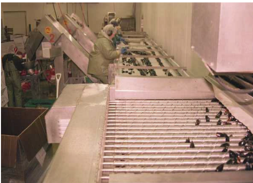
Fremst á myndinni má sjá stærðarflokkara, þá gæðaflokkunarband og aftast sést í vigtunar- og pökkunarbúnað.
