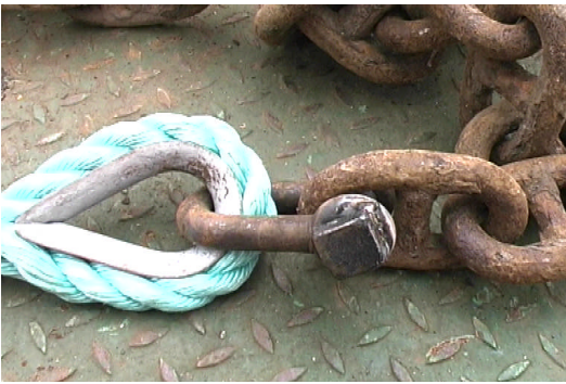
Kós í augnsplæsi á kaðli sem festur er í keðju. Bolti í lás er lóðaður fastur.
