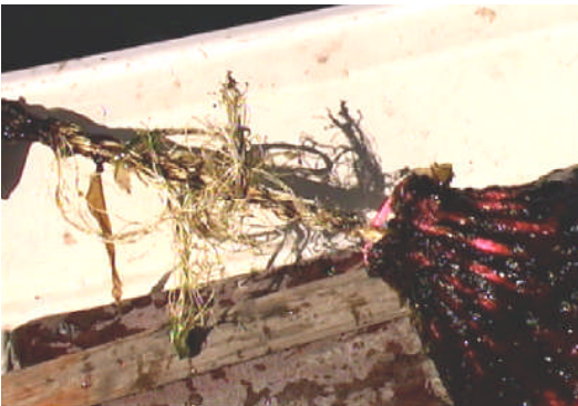
Flottóg á línubelg byrjað að slitna. Hér vantar að klæða tógið með slöngu til að hlífa því.
