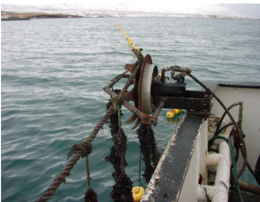
Leiðari sem samanstendur af stjörnuhjólí. Á stjörnuhjólí eru armar og fara ræktunarbönd á milli þeirra þegar bátur fer með línu.
