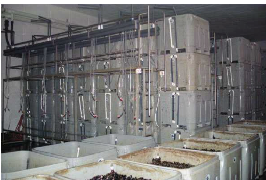
Geymslukör með sírennsli fyrir lifandi krækling.
