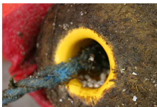
Mynd 2.12. Hróðurkarl inni í opi á nótarfloti byrjaður að skera flottógið.
