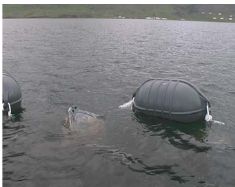
Mynd 2.9. Flot sem sukku á Exploralínunni þakin hrúðurkarli. Nýjum flotum hefur verið bætt á línuna til að halda henni upp í yfirborði sjávar.
