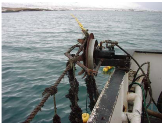
Mynd 2.1. Glussa drifíð hjól á bát Norðurskeljar ehf. (Mynd; Björn Theodórsson)
