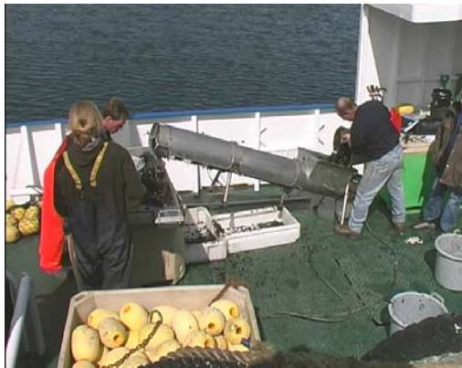
Mynd 5.1. Kræklingur losaður í sundur í afklasara hjá Norðurskel ehf. um borð í gömlu Hríseyjarferjunni.
