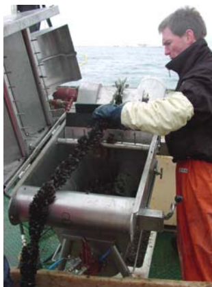
Mynd 2.2. Uppbygging á afþræðara (Mynd; Björn Theodórsson)
