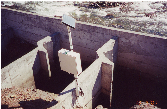
Mynd 1. Árvaka fiskteljari í fiskvegi í Kambsfossi í Austurá. Myndin er tekin í júní 2001.
