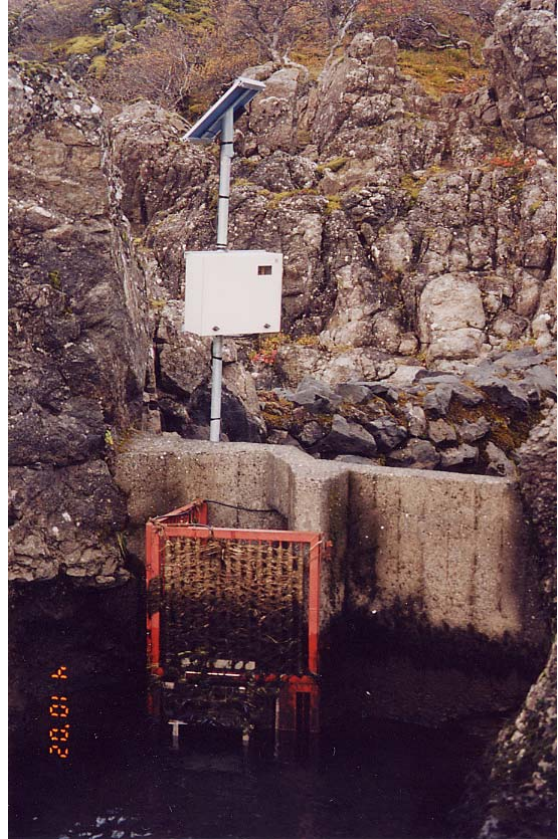
Mynd 1. Árvaka fiskteljari í fiskvegi í Glanna í Norðurá. Myndin er tekin 4. október 2002.
