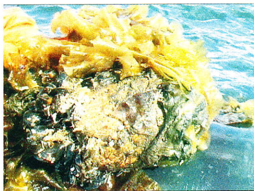
Mynd 2.5. Gamalt rauðbrúnt nótarflot á kræklingalínu við Bjarteyjarsand. Flotið er búið að vera rúm tvö ár í sjó og sést í það þar sem búið er að hreinsa af áætur.
