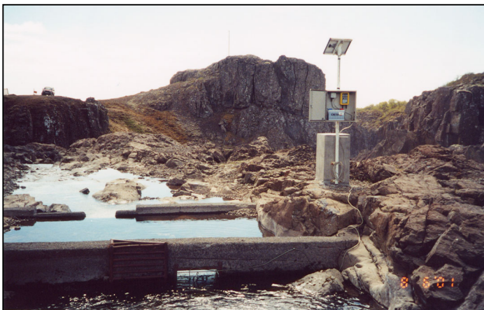
Mynd 1. Árvaka fiskteljari í fiskvegi í Sveðjufossi í Langá. Myndin er tekin 8. júní 2001.
