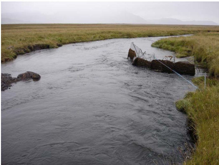
Fyrirstaða fyrir teljara í Grímsá óvirkur eftir flóð haustið 2007.
