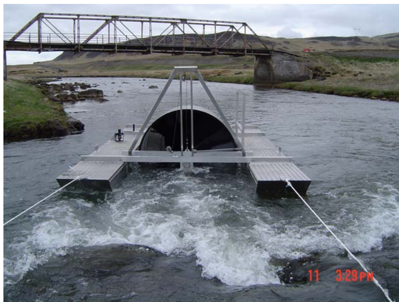
Ljósmynd 1. Snúningsgildran í Kálfá komin á sinn stað. Þetta er í fyrsta skipti sem slíkt verkfæri var reynt á Íslandi. Í baksýn er Stöðulfell.
