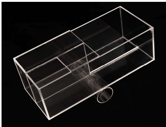
Mynd 1. Tvær gerðir hlutsýnataka til að taka hlutsýni af botnlægum hryggleysingjum í straumvötnum og af fjörusvæði stöðuvatna. Rörið undir ferkantaða sýnadeilinum (t.v.) er notað til að velta honum fram og
