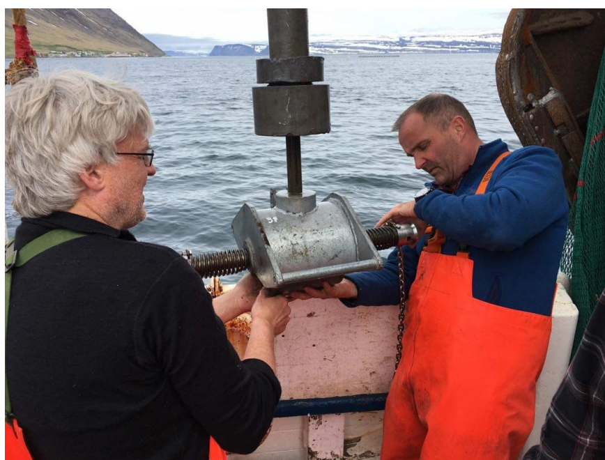
2. mynd. Shipek botngreip tekin inn og greiparskálín losuð (ljósm. Rakel Guðmundsóttir).
