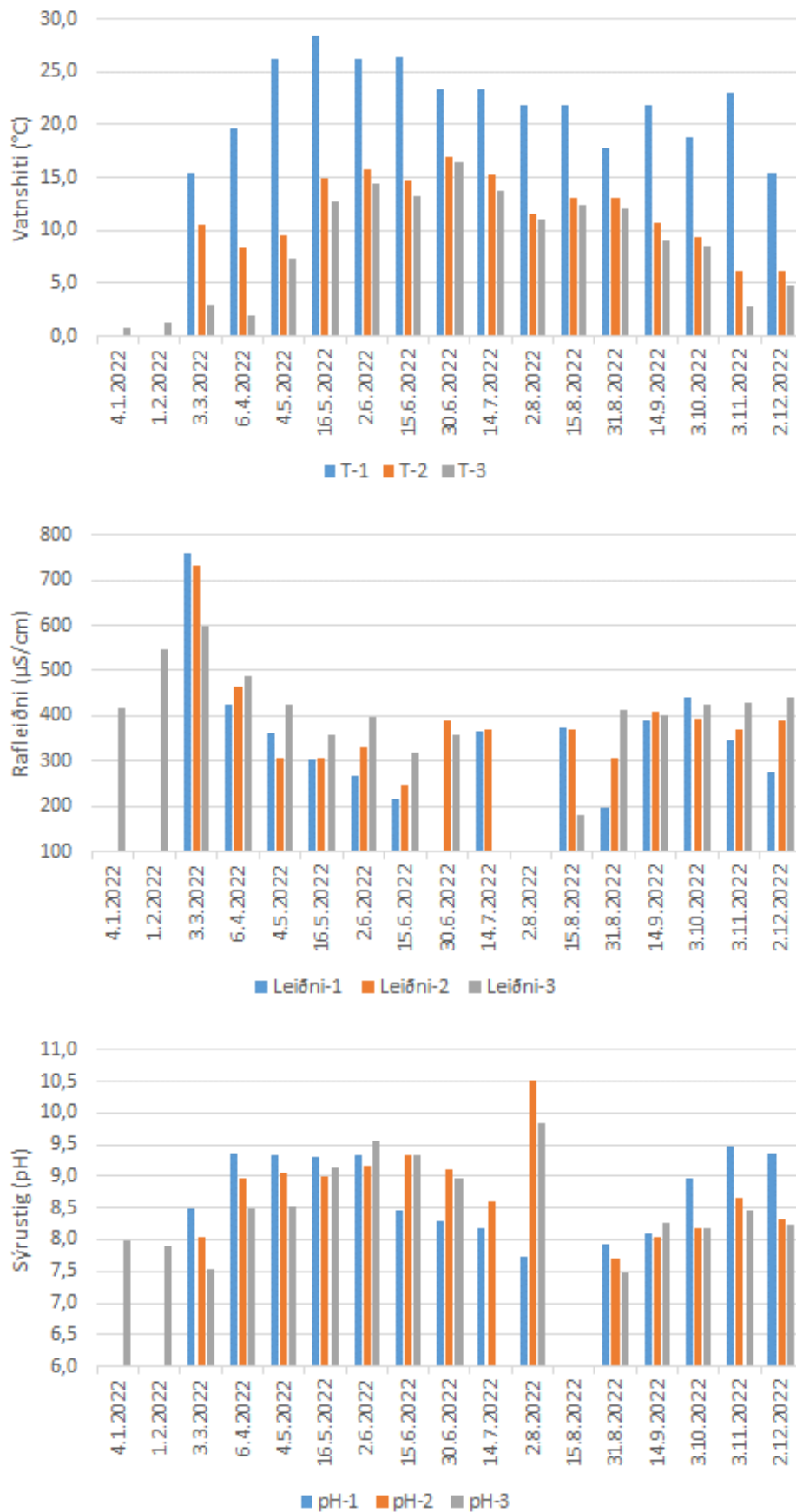
Mynd 3. Vatnshiti (°C), rafleiðni (µS/cm) og sýrustig (pH) á sýnatökustöðvum nr. 1 og 2 í Vatnsmýri og nr. 3 við Skothúsveg árið 2022.
