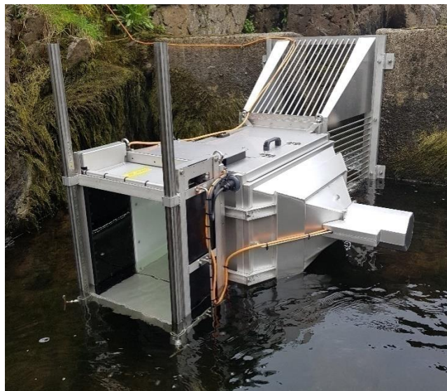
5. mynd. Teljari í Laugardalsá í Ísafjarðardjúpi er útbúinn með skynjurum, myndavél og ljósum.
