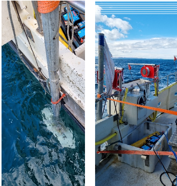
3. mynd. Ljósmyndir af uppsetningum á bergmálmælum á Guðrúnu ÞH. Figure 3. Images of the setup of acoustic equipment onboard Gudrun ÞH.
