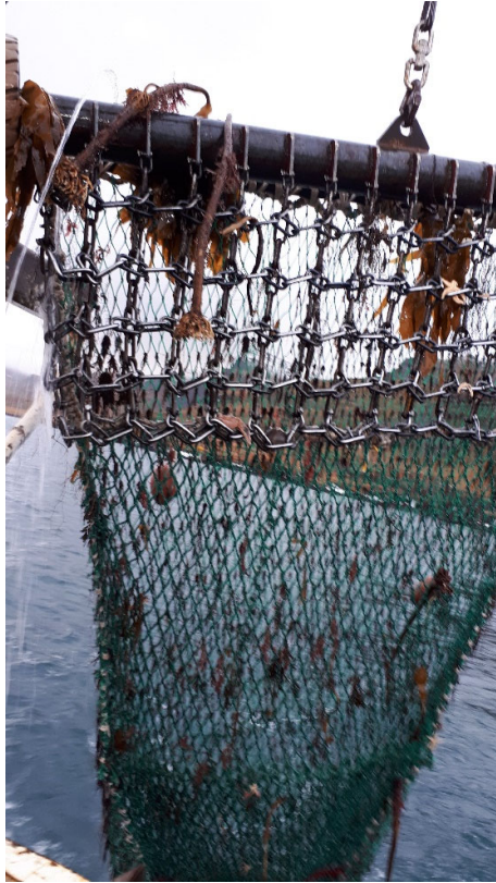
5. mynd. Ígulkeraplógur um borð í Eyja NK-4. Figure 5. Sea urchin dredge used in the investigation.
