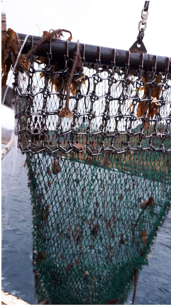
6. mynd. Ígulkeraplógur um borð í Eyja NK-4. Figure 6. Sea urchin dredge used in the investigation.
