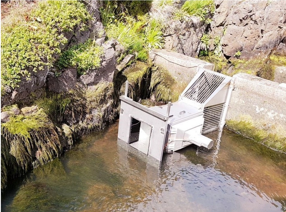
2. mynd. Teljari í fiskvegi í Einarsfossi. Til að minnka truflanir vegna gróðurs voru m.a. settar plötur út fyrir efra op teljarans og hann þéttur.
