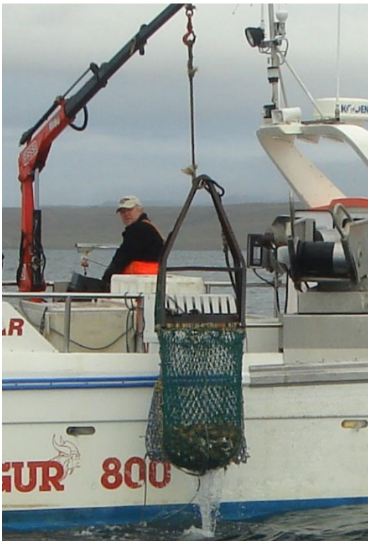
4. mynd. Lítil tannplógur til kúfiskelveiða. Ljósmynd./Photo: Guðrún Þórarinsdóttir.
