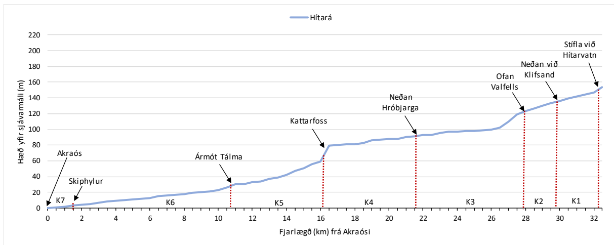
6. mynd. Langsnið af Hítará á Mýrum. Hæð yfir sjávarmáli (hys) og kaflaskiptingar eru sýndar.
