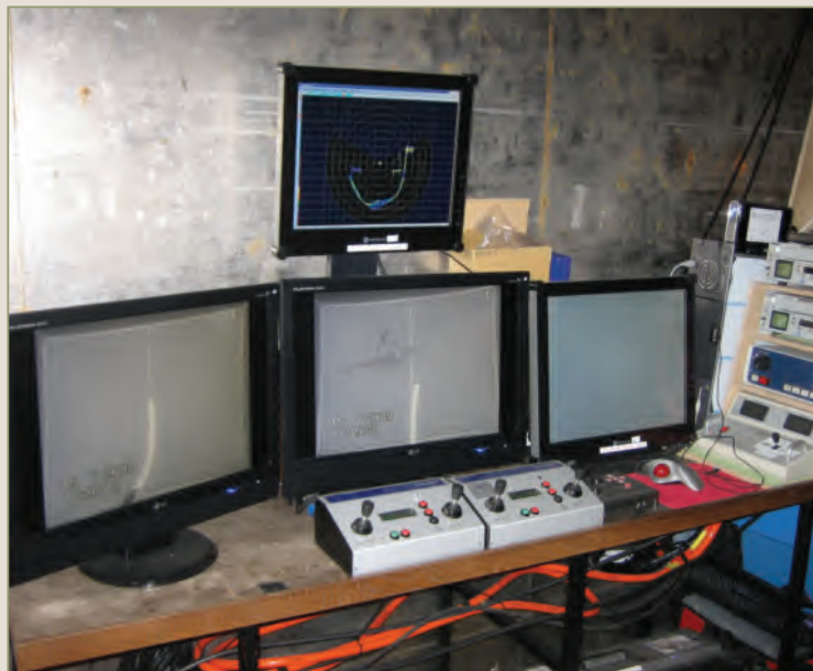
5. mynd. Hægt var að fylgjast með atferli fiskanna á stórum tölvuskjám inni í gámnum. Á tveimur sjást fódurpallarnir og einn fiskur er á öðrum pallinum. Í miðri kví var komið fyrir sónar sem sýndi þversnið af kvínni (efsti skjáinn).
