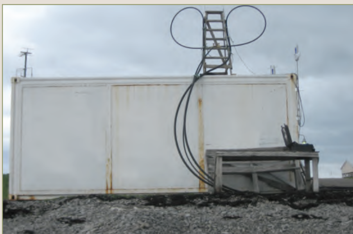
2. mynd. Á fjörukambinum var gámur með tækjabúnaði. Sjó var dælt stöðugt í tvö rör sem opnuðust uppi á gámnum. Þar var fódrið sett í og því skolað út á fódurpalla í kvínni.
