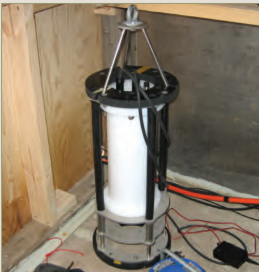
3. mynd. Hljóðdufl hannað af Stjörnu-Odda var notað til að gefa lágtíðnihljóð (250 Hz) rétt fyrir og meðan fódrun stóð yfir. Duflið var beintengt við tvo hljóðsenda (transducers) sem komið var fyrir við fódurpallana.
