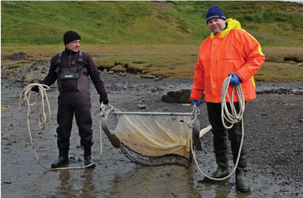
5. mynd. Bjálkatrollið sem notað var við sýnatökur í Þorskafirði, Djúpafrði og Gufufirði í frumathugun Hafrannsóknastofnunar í ágúst 2015 (ljósm. Hjalti Karlsson).
