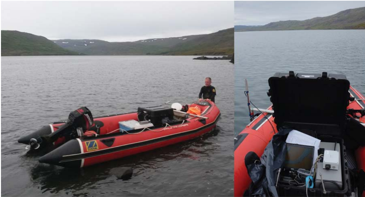
7. mynd. Slöngubáturinn ásamt botnstykkinu sem notað var við bergmálmælingar í Þorskafrði í frumathugun Hafrannsóknastofnunar í ágúst 2015 (ljósm. Hlynur Pétursson).
