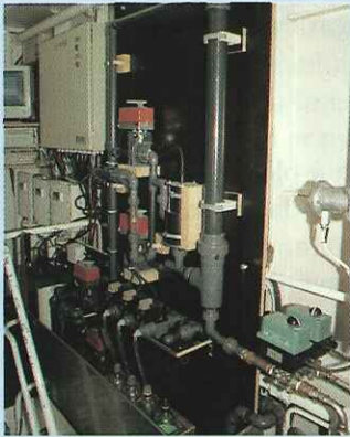
1. mynd. Uppsetning mælitækjanna um borð í Herjólf. Ljósmynd: Kristinn Guðmundsson. Figure 1. Setup for automated flow through measurement of chlorophyll-a onboard the ferry Herjólfur.
