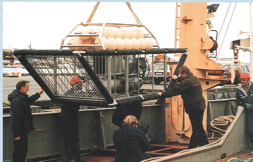
11. mynd. Merkingarbúnaðurinn hífdur um borð í Bjarna Sæmundsson. Trekt beinir fiskinum að rennu í miðju tækisins þar sem hann er skorðaður og merktur með rafeindamerki. Aðgerðinni er stjórnað frá rannsóknaskipinu, með aðstoð myndavélar. Ljós. Þorsteinn Sigurðsson.
