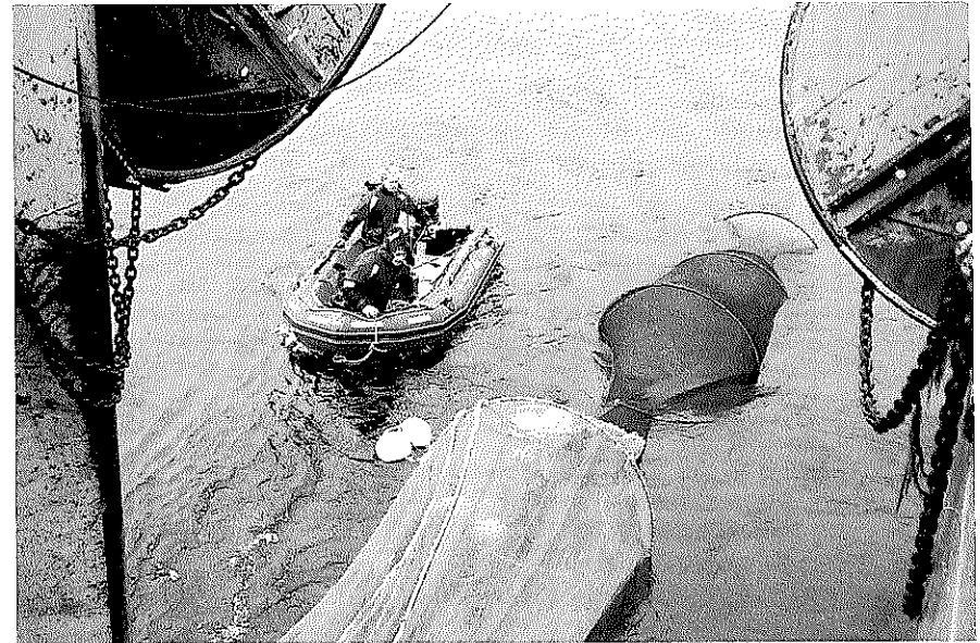
18. mynd. Við athuganir á lifsslíkum seiða eftir smug í gegnum möskva á rækjuvörpu voru notuð netbúur sem sett voru utan um pokann á vörpunni. Búrunum var sleppt á 20 m dýpi þar sem kafarar fylgdust með afkomu seiða í þeim í nokkra daga (ljósm. Guðmundur Þórðarson).
