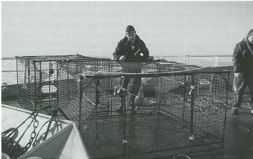
20. mynd. Þorsgildrur á framþilfari á rs. Árna Friðrikssyni. Gildrurnar hafa ekki reynst mjög fiskgæfar við Ísland. (Ljós. Guðmundur Þórðarson).
