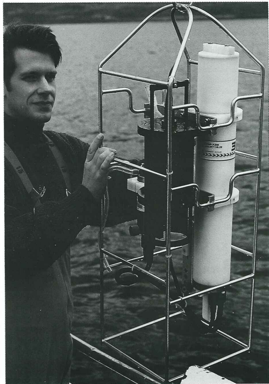
22. mynd. „Sonda“ notuð til mælinga á breytingu á seltu og hita með dýpi í Eyjafirði (ljósm. Øivind Kaasa).
