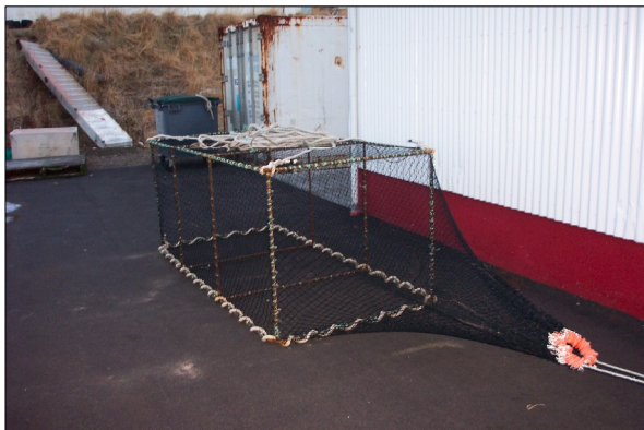
Mynd 2.4. Búr sem notað var hjá Þorskeldi til að ná lofti úr flotþorskum með því að sökkva því vel undir yfirboð sjávar (Ljós.: Elís Hlynur Kjartansson).
