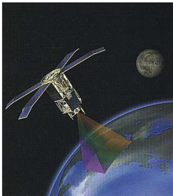
25. mynd. SeaWiFS fjölgeislamælir er um borð í gervitunglu SeaStar, í 705 km hæð á sporbaug yfir pólsvæðum og skráir litbrigði á yfirborði jarðar.
