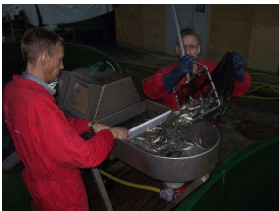
23. mynd. Sjálfvirk talning á þorskseiðum í Tilraunaeldisstöðinni á Stað. Teljarinn getur talið seiði allt niður í 0,2 g.
