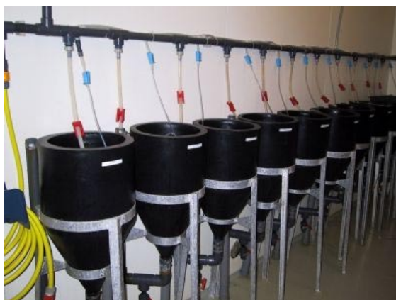
8. mynd. Hrognaklefi í eldisstöðinni á Stað. Myndin sýnir hrognasíló með loft- og sjóslöngum.
