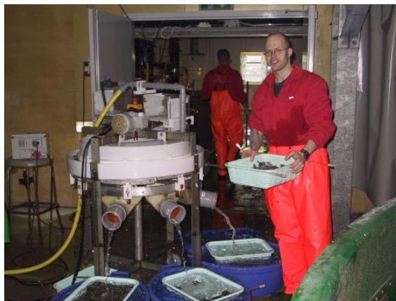
22. mynd. Sjálfvirk stærðarflokkun á sandhverfuseiðum í eldisstöðinni á Stað. Flokkarinn hefur átta rásir en er stilltur á flokkun í þrjá stærðarflokka.
