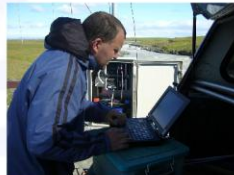
6. mynd. Hugð að göngum úr sjálfvirkri leitarstöð útvarpsmerkja á gömlu Þjórsárbrú. Stöðin skráir hvernar merktir fiskar ganga framhjá.
