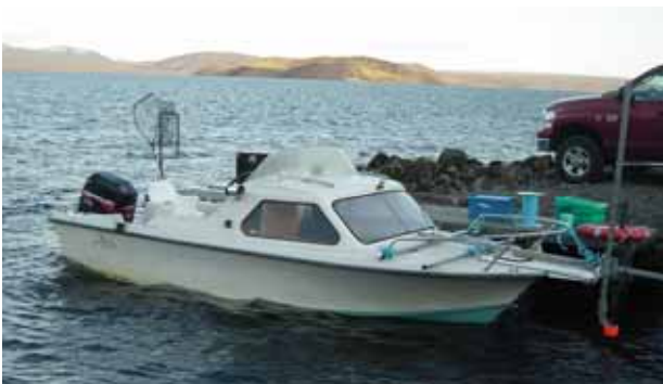
Báturinn sem notaður var til bergmálmælinga á Þingvallavatni haustið 2008. Hljóðsendar/-móttakari er festur á slá framan á bátinn og tengdur við tölvubúnað inni í bátum sem stýrir sendingum og skráir endurkastið. Ljós. Veiðimálastofnun.
