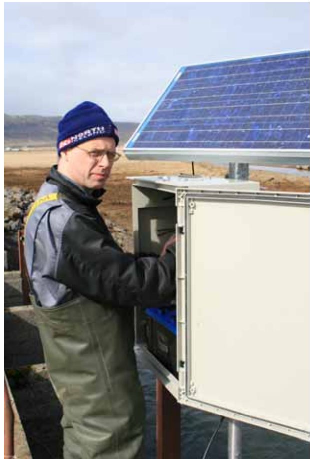
Ingi Rúnar Jónsson við uppsetningu á fiskteljara í Varmá í Ölfusi. Ljós. Magnús Jóhannsson.
