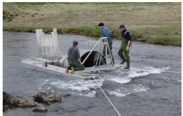
Uppsetning rotary screw gönguseiðagildrunnar í Kálfá (Ljósmynd Ingi Rúnar Jónsson)
