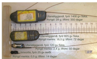
Myndin sýnir mismunandi gerðir útvarpsmerkja. Þau draga á eftir sér loftnet sem miðlar útvarpsbylgjum í púlsum. Hvert merki sendir á sérstakri tíðni, sem er um leið einkennandi fyrir hvern fisk. Veiðimálastofnun hefur leyfi frá Póst og fjarskiptastofnun til að nota tíðnisviðið 150,0625 MHz – 152,000 MHz til rannsókna sinna.
