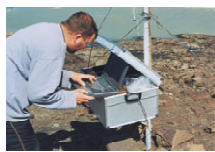
Leitargögnun hlæðir á fartölvu úr sjálfvirkri leitarstöð. Leitarstöðin sefur aldrei, hún hlustar stöðugt eftir sendingum merkjanna og skráir árangurinn í minni sitt.
