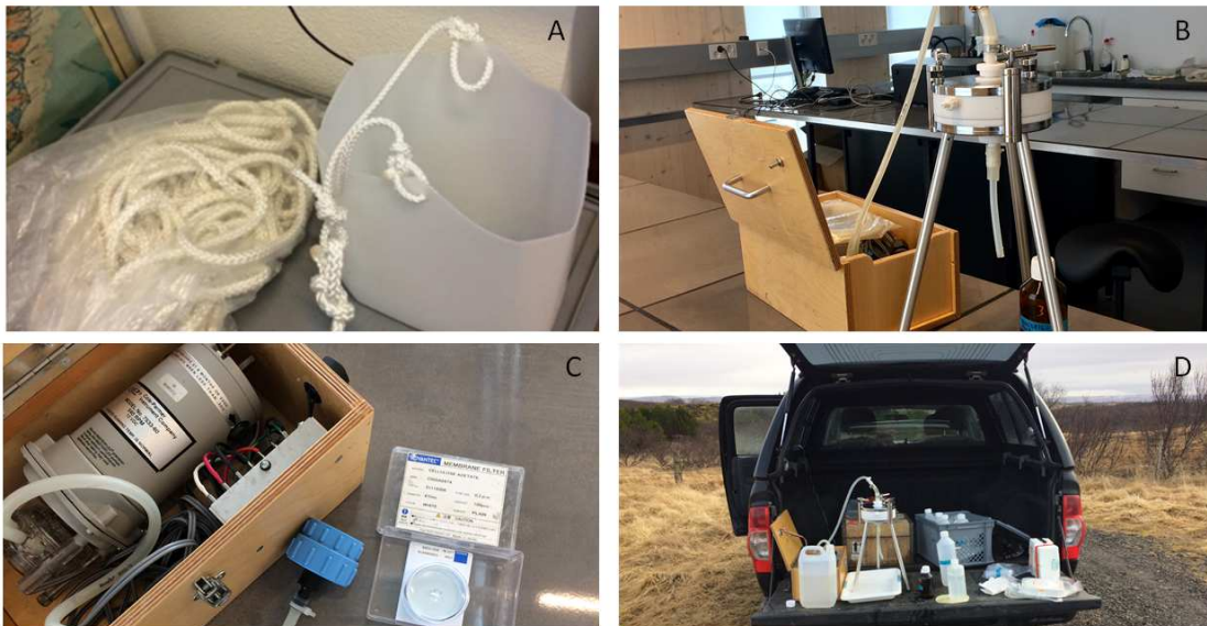
Mynd 2. A) Dæmi um sýnatökubúnað sem hægt er að notaða við vatnssýnatökur. Búið er að skera ofan af ónotuðum plastbrúsa sem er laus við öll litarefni. B) stór síuhaldari (142 mm), peristaltísk dæla. C) peristaltísk dæla, in-line plast síuhaldari (47 mm) og viðeigandi síur. D) Dæmi um uppsetningu síubúnaðar í felti.
