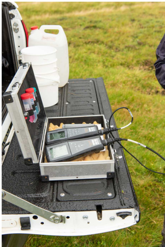
Mynd 6. Byrjað er á að staðla þá mæla sem nota á í feltinu. Nauðsynlegt að staðla pH mæla daglega og súrefnismæla þarf að staðla á hverjum stað. Leiðnimælar eru stöðugir miðað við hina en þá skal engu að síður staðla fyrir hvern leiðangur.
