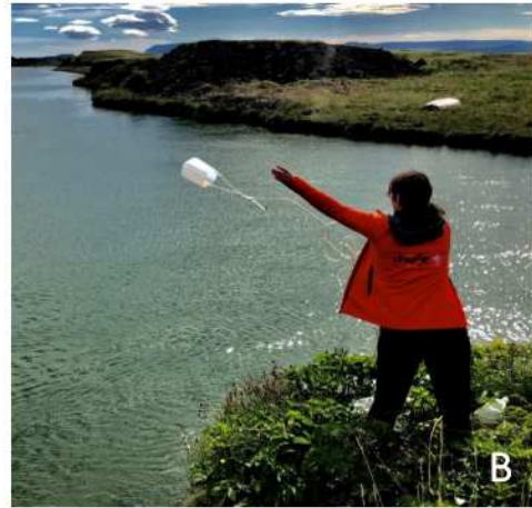
Mynd 3. Sýnataka í straum- og stöðuvötnum. A) Sýnataka í straumvatni: Sýnatökubrusanum er beint upp í strauminn og sýnatökumaðurinn stendur fyrir neðan. B) sýnataka af bakka straum- eða stöðuvatna: Fötu í bandi er kastað vel út í vatnið og dregið í land. Í báðum tilvikum er mjög mikilvægt að flátið sem sýnum er safnað í sé hreint og að óhreinindi frá nánasta umhverfi berist ekki í sýnið.
