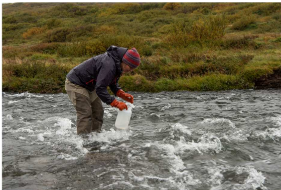
Mynd 7. Sýnum er safnað beint í brúsa upp í strauminn. Brúsinn er þveginn þrisvar áður en hann er fylltur.
