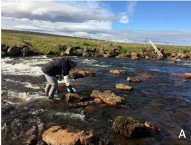
Mynd 3. Sýnataka í straum- og stöðuvötnum. A) Sýnataka í straumvatni: Sýnatökubrusanum er beint upp í strauminn og sýnatökumaðurinn stendur fyrir neðan. B) sýnataka af bakka straum- eða stöðuvatna: Fötu í bandi er kastað vel út í vatnið og dregið í land. Í báðum tilvikum er mjög mikilvægt að flátið sem sýnum er safnað í sé hreint og að óhreinindi frá nánasta umhverfi berist ekki í sýnið.
