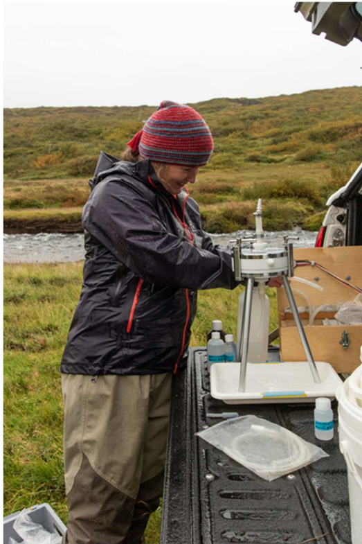
Mynd 8. Sía er sett í síuhaldarann, síuhaldarinn er tengdur við peristaltíska dælu og vatni er dælt í gegnum síubúnaðinn. Fyrst þarf að skola búnaðinn með því að dæla vatnssýninu í gegn um hann, áður en byrjað er að safna í flöskur.
