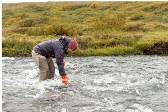
Mynd 7. Sýnum er safnað beint í brúsa upp í strauminn. Brúsinn er þveginn þrisvar áður en hann er fylltur.
