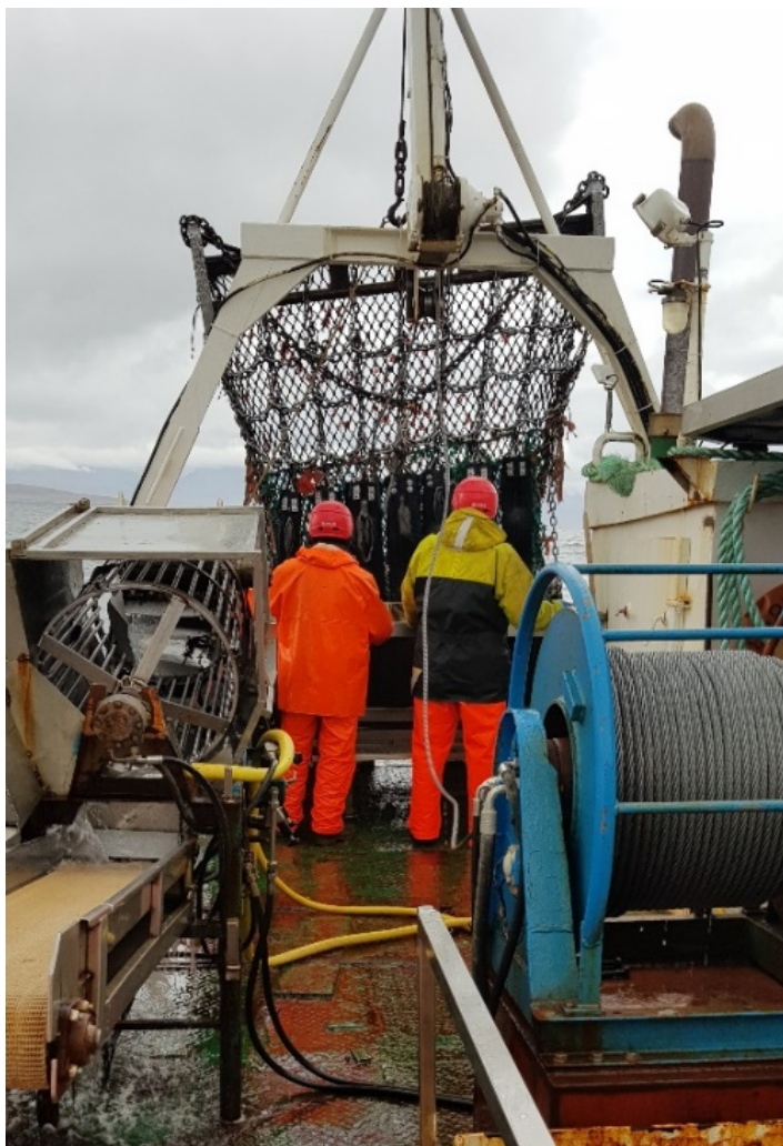
5. mynd. Ígulkeraplógur um borð í Sjöfn SH707. Fig. 5. Sea urchin dredge used in the investigation. Ljósm. /Photo: Guðrún Þórarinsdóttir.
