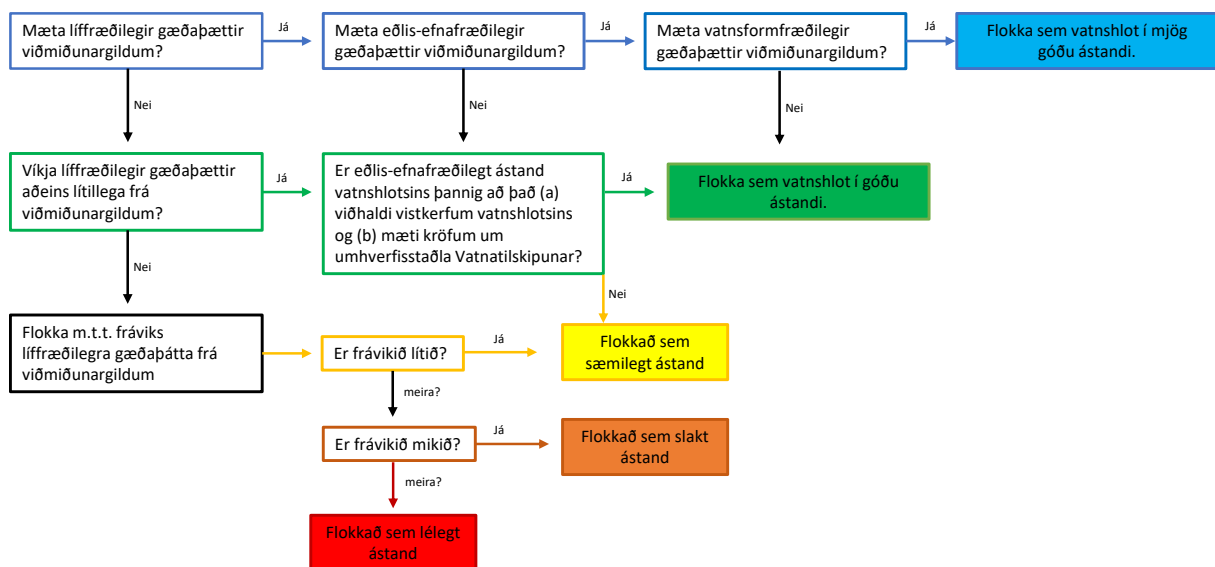
Mynd 42. Flokkunarlykill Vatnatilskipunar sem sýnir afstætt hlutverk líffræðilegra, eðlis-efnafræðilegra og vatnsformfræðilegra gæðapátta við flokkun vatnsfalla eins og gert er ráð fyrir í Vatnatilskipun (WFD CIS, 2003a). Indication of the relative roles of biological, hydromorphological and physico- chemical quality elements in ecological status classification.
